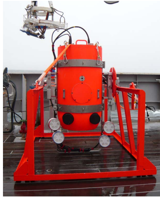
図3 垂下中のJ-QUEST \alpha 。ターゲットストレングス測定（下向き観測）（写真左）。 魚種、体長、遊泳姿勢の測定（横向き観測）（写真右）。
