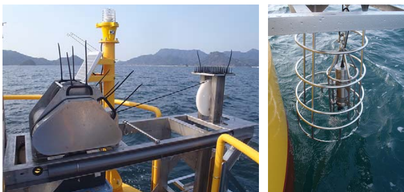
図2. 多項目水質計の自動昇降装置(左:ウインチ部、右:海面上の多項目水質計)
