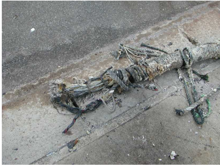
急潮により破断したワイヤー（径 36mm）
