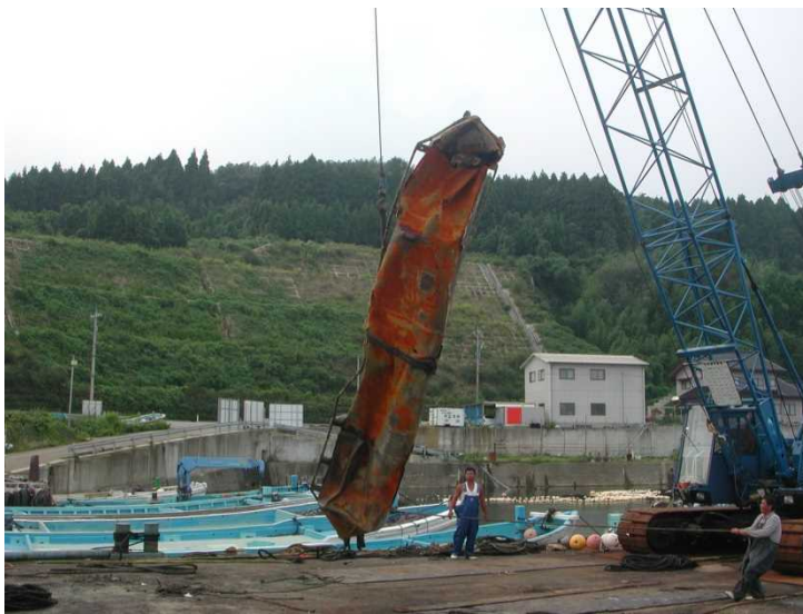
急潮により水深深くまで引き込まれて圧壊した鉄製の浮き (台浮子：だいあば)
